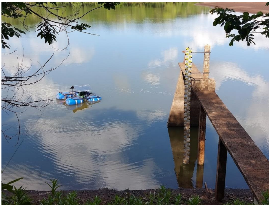
Figura 3 – Sistema de bomba flutuante para captação forçada e nível d'água abaixo da régua limnimétrica
